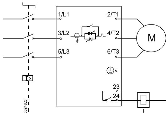
*Avviatore statico installato con interruttore automatico magnetotermico e contattore di rete di protezione del sistema*
