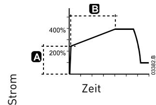
Die Rampenzeit ist nicht die Zeit, die der Motor bis zum Erreichen der vollständigen Drehzahl benötigt.
