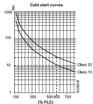
Die Einstellung der Motorschutzklasse auf "Off", deaktiviert den Motorüberlastschutz.
