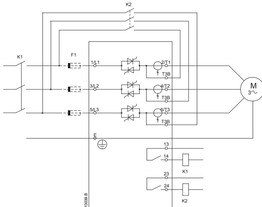
电源连接 — 星形连接法，外置旁路(EMX3-0360C~EMX3-1600C)
