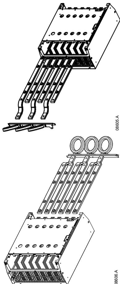
10. 取下磁分路片固定螺丝，取下磁分路片（仅 EMX3-0620C~EMX3-1600C 型）。
