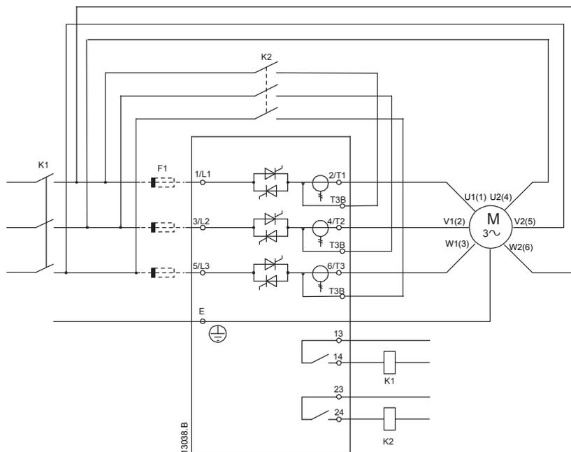
电源连接 — 三角形连接法，外置旁路 (EMX3-0360C~EMX3-1600C)
