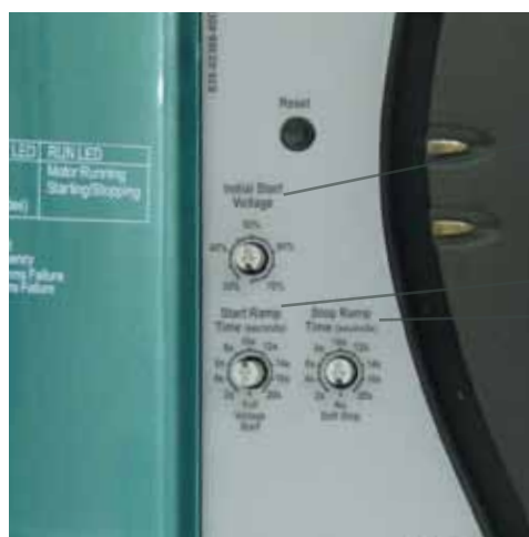
Панель управления CSX
